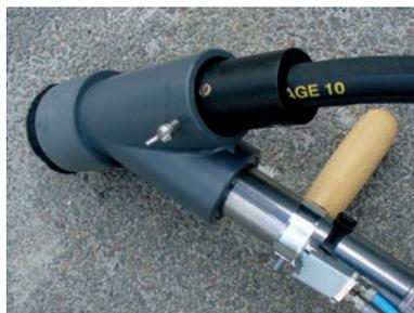
Dans le cas d'utilisation de corindon, il est conseillé d'utiliser une buse en carbure de bore en remplacement de la buse en carbure de tungstène fournie d'origine.
